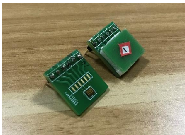
图 5.6 带简易盖板的加速度计
