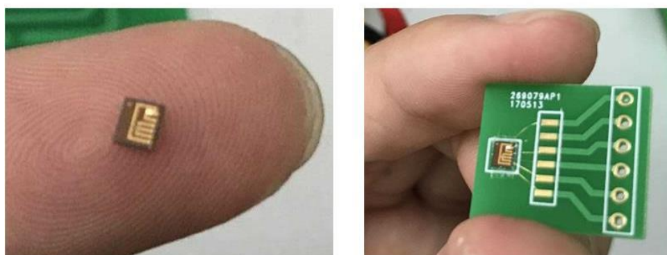
图 4.18 划片和引线键合后的芯片
