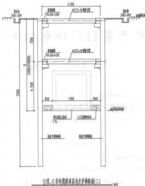
D段、E段电缆隧道基坑支护横断面(二)
